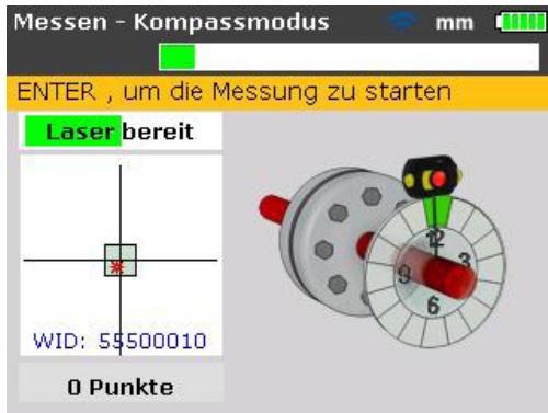
Abbildung 6-3. Reflektierten Laserstrahl mit Einstellschraube und gelbem Rändel zentrieren
