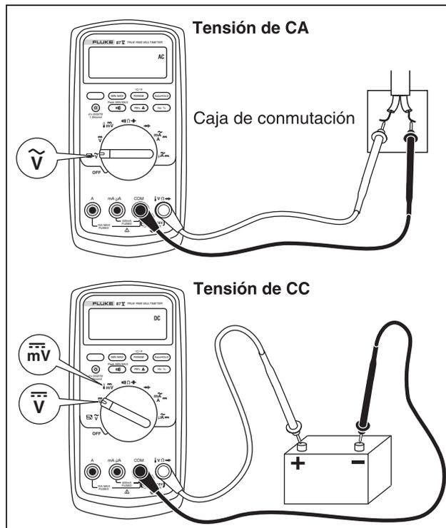
**Figura 2. Medición de tensiones de CA y CC**
