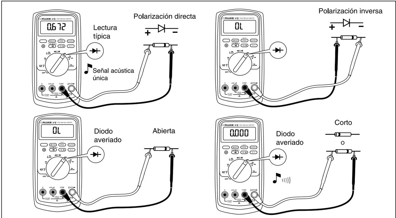
Figura 7. Prueba de un diodo
