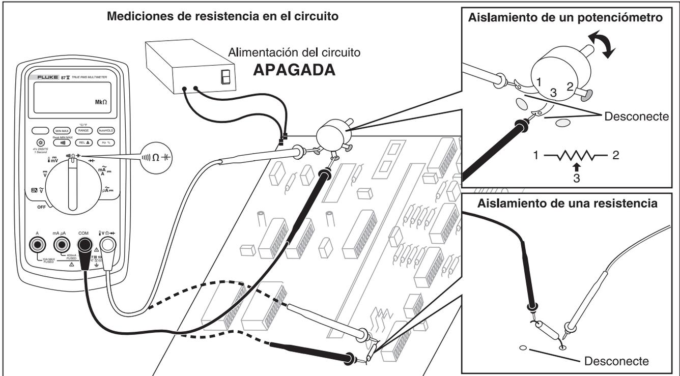
Figura 5. Medición de resistencia
