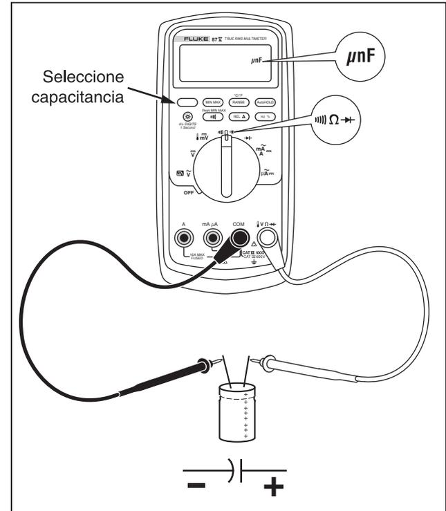
Figura 6. Medición de capacitancia
