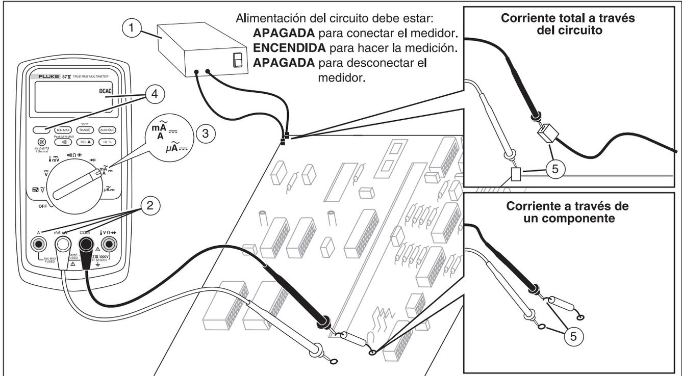
Figura 8. Medición de corriente
