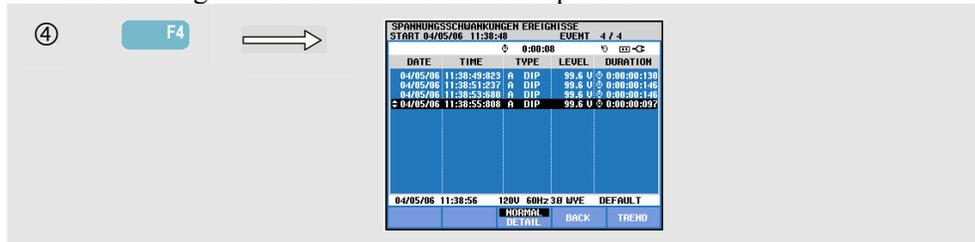
Die Ereignistabelle listet alle Überschreitungen der Schwellenwerte von Phasenspannungen auf. Als Schwellenwerte können internationale Standards oder benutzerdefinierte Schwellenwerte verwendet werden. Für eine Anpassung der Schwellenwerte benutzen Sie die Taste EINST. und gehen dann zu Grenzwerte. Nähere Informationen finden Sie im Kapitel 20, Einstellen von Grenzwerten.
