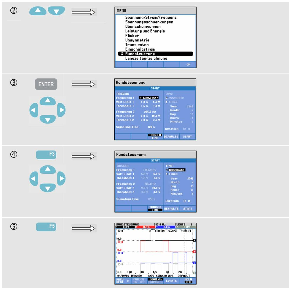
Die graphische Darstellung auf dem Bildschirm erfolgt von rechts nach links. Die in der Kopfzeile angezeigten Messergebnisse entsprechen den aktuellsten Werten, die ganz rechts aufgezeichnet werden. Mit den Pfeiltasten nach oben/unten können Sie eine Anzeige als Prozentsatz der Netznennspannung oder als über 3 Sekunden gemittelte Spannung (V3s) auswählen.
