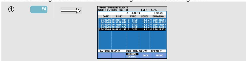
Die Ereignistabelle gibt im Modus NORMAL die während einer Messung aufgetretenen Ereignisse an (V3s über dem Grenzwert). Datum, Zeit, Typ (Phase, Signal 1 oder Signal 2), Pegel und Dauer aller Ereignisse werden aufgelistet. Im Modus DETAIL werden zu den Überschreitungen der Schwellenwerte zusätzliche Informationen angezeigt.
